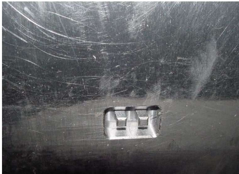
Abbildung 2: herausgearbeitete Proben ca. 5 x 5 x 15 mm
