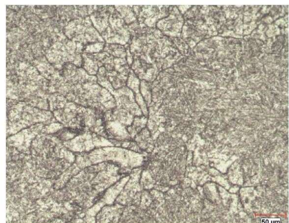
Abbildung 3: links, schlechtes Glühgefüge, dessen Strukturen auch noch nach dem Härten (rechts) vorliegen und sogar noch deutlicher hervortreten.
