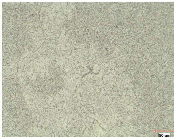
Abbildung 3: links, schlechtes Glühgefüge, dessen Strukturen auch noch nach dem Härten (rechts) vorliegen und sogar noch deutlicher hervortreten.
