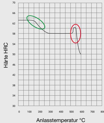
Bei Stählen **mit Sekundärhärte** können hohe Härten sowohl bei niedrigen (primär) als auch bei höheren (sekundär) Temperaturen erreicht werden (primär: 63-60 HRC; sekundär: 60 HRC und niedriger).
